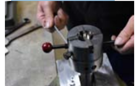
6. Feststellen / Lösen der Konterschraube
