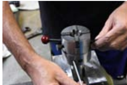
5. Lösen der Gegenschraube zur Gewinde-Feineinstellung
