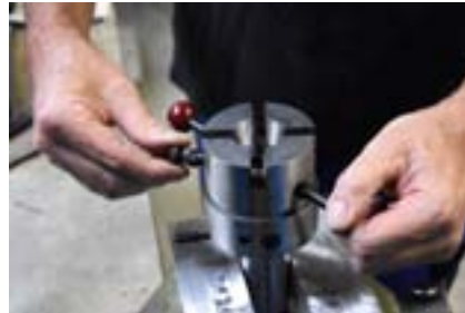
2. Zurückziehen der Schließkurve mittels Auszieher
