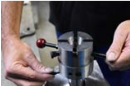
1. Öffnen des Gewindeschneidkopfes durch Zurückziehen des Umlegehebels
