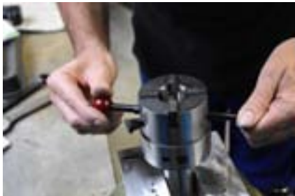
4. Schließen des Gewindeschneidkopfes durch Linksdrehen des Kurvenstückes
